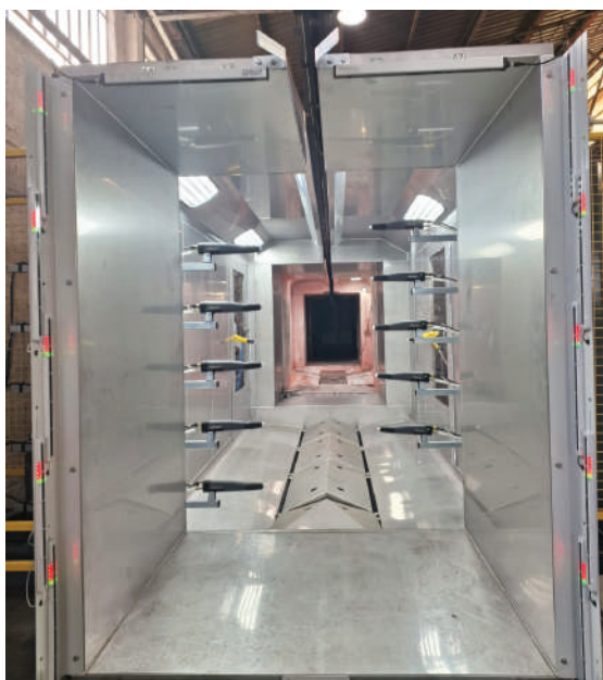
Cabine de Pintura a Pó, que realiza a leitura da geometria da peça para realizar o processo de forma automatizada.
