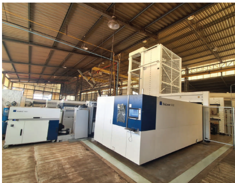
03 máquinas corte laser, com capacidade de corte de até 32mm. Sendo a última adquirida, com automação para operação sem intervenção do operador.
