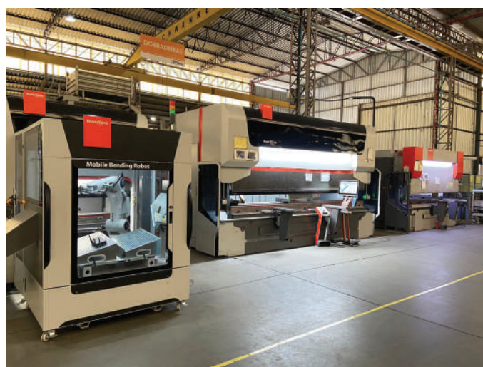
Recente investimento: robotização de uma das máquinas e aquisição da 5ª dobradeira, com capacidade para 400 toneladas.
