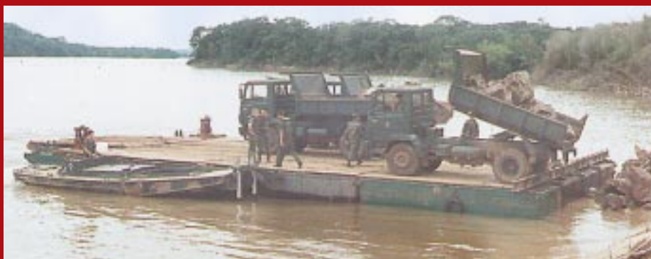
PORTADA FITA com 16 uniflotes, em obra contratada pela Administração das Hidrovias do Sul, na barragem de Amarópolis, em General Câmara (RS)
